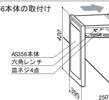
ベースプレートにかぶせる様にして本体を付属の六角レンチにて皿ネジを4点締付け、取付けます。
