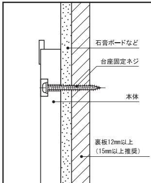
●下地には必ず、指定の厚みの裏板もしくは桟木を入れ、補強してください。(補強が弱いと、落下してケガや重大事故の恐れがあります。)
