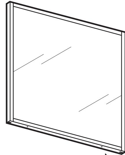
●フレームの内側の溝にさきに上の固定金物を2箇所はめます。その後、下の固定金物もはめます。
