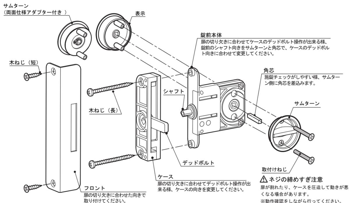
表示器取付位置 ※デッドボルト向き (室内・室外) は、扉側と枠側の切欠き向きにより逆勝手対応可能
