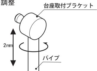
パイプは台座取付ブラケットにきつく差し込んであるだけのフリーな状態ですので片側2mm上下4mm程度の寸法調整が出来ます。
